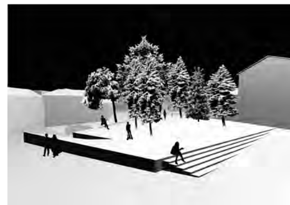
Legenda: 1. Pavimentazione in serizzo bianco - 2. Scala in serizzo bianco - 3. Pavimentazione in serizzo bianco - 4. Panca in serizzo bianco - 5. Corpo illuminante - 6. Essenze arboree - 7. Fascia carrabile in porfido - 8. Rampa - 9. Pista ciclabile in asfalto colorato - 10. Cordoli in cls prefabbricato - 11. Marciapiede in porfido
