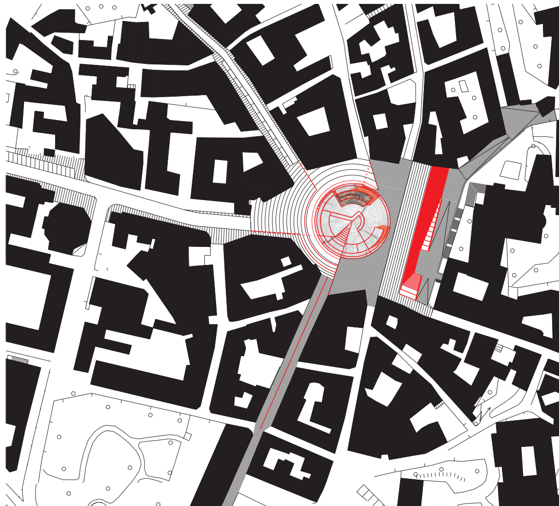
1-EDICOLA 2-BAR 3-PANCHINE 4-SEDUTE PROTETTE 5-GRADINI 6-RAMPE 7-AREA ALBERATA 8-GRADINATA 9-TERRAZZA PANORAMICA ATTREZZABILE 10-LASTRE IN PORFIDO 11-BLOCCHI IN GRANTO 12-ZONA CARRABILE 13-ZONA PEDONALE 14-ZONA PEDONALE/CARRABILE 15-OMBRE H 10 AM 21 GIUGNO 16-OMBRE H 1 PM 21 GIUGNO 17-OMBRE H 16 PM 21 GIUGNO
